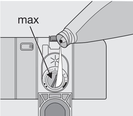
3. Essayez le liquide de rinçage accidentellement renversé avec un chiffon absorbant pour éviter la formation de mousse pendant le programme de lavage.
